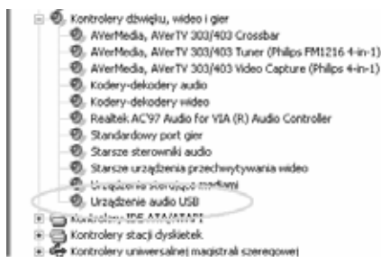
Rys. 7. Po dołączeniu karty do komputera w Menadżerze urządzeń pojawia się nowe urządzenie
